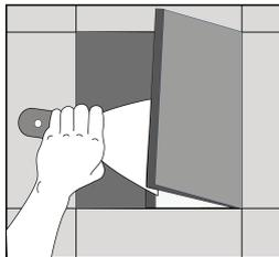
При помощи шпателя поднимите части планки от центра к краю. Этот способ поможет избежать повреждения соседних планок.
