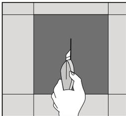
Чтобы удалить поврежденную планку, разрежьте ее ножом на две или четыре части по центру.
