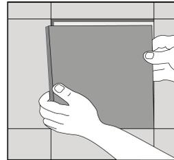
Используйте рекомендованный контактный клей для монтажа новой планки. Следуйте инструкции на упаковке.
